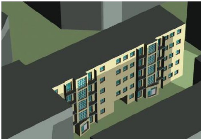
Vue sur la Modélisation 3D de la Simulation Thermique Dynamique sur le logiciel Pléiades
